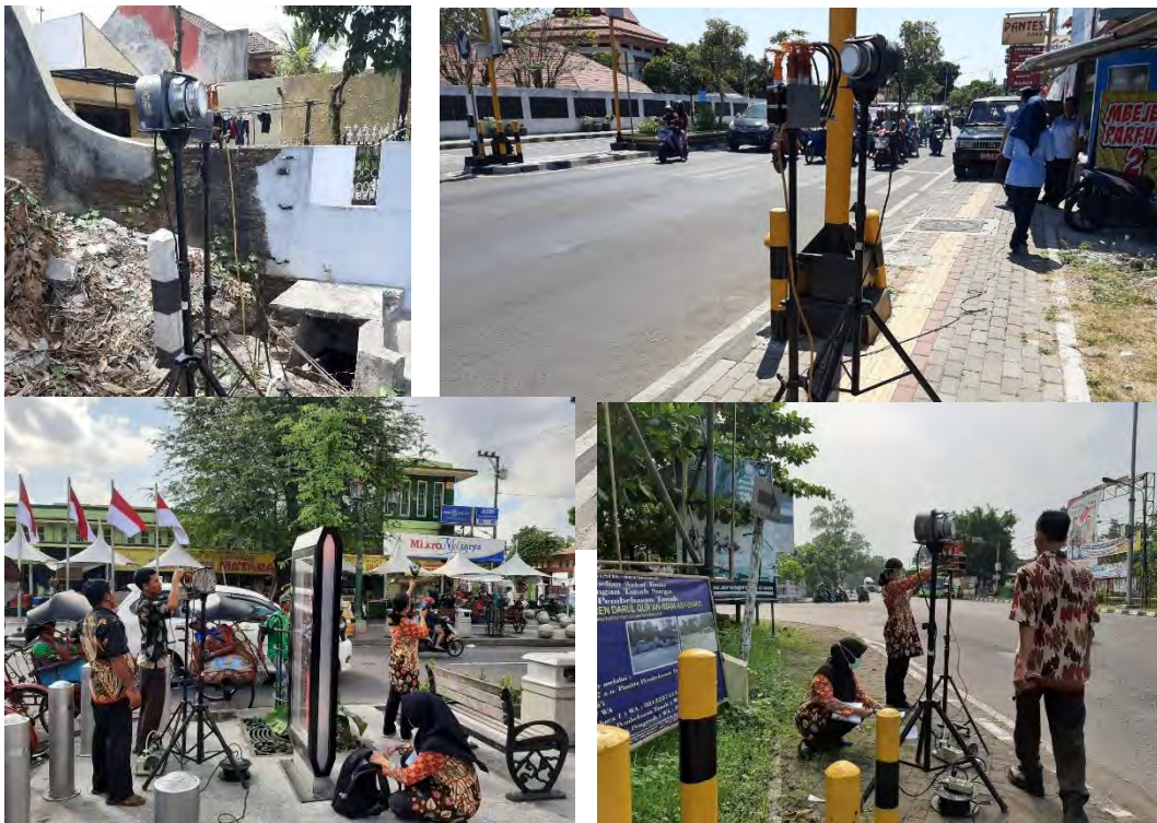
Gambar 2.22 Pengambilan Sampel Kualitas Udara Ambien Metode Aktif
