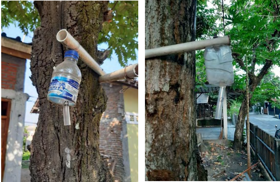
Gambar 2.21 Pemasangan sampel Kualitas Udara Ambien Metode Pasiif
